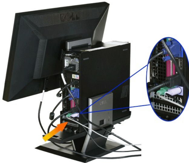
8. ในการจัดเส้นทางสายเคเบิลผ่านช่องเปิดของช่องเก็บสายเคเบิล
